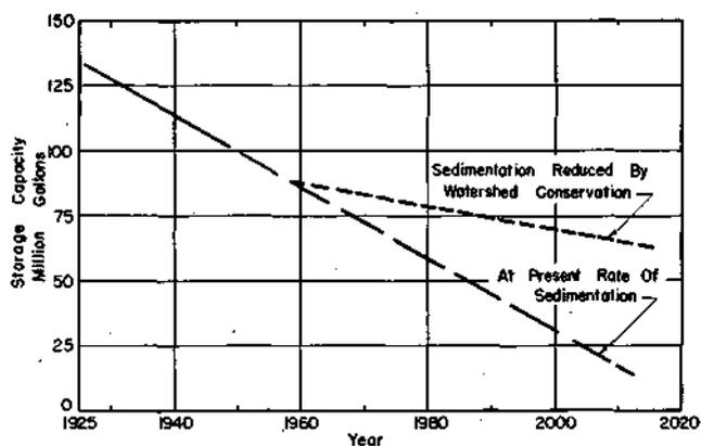
FIG. 9. DECREASE IN STORAGE CAPACITY DUE TO SEDIMENTATION—LAKE CARTHAGE.
