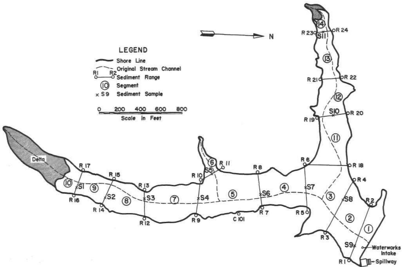
FIG. 2. LAKE CARTHAGE—1949 SEDIMENTATION SURVEY.
