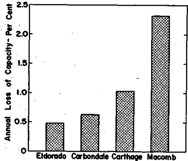
FIG. 4. LAKE CARTHAGE STORAGE LOSS COMPARED TO OTHER ILLINOIS RESERVOIRS.
