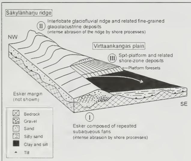
**Figure 3** The structural zones of the Säkyänharju-Virttaankangas complex.
