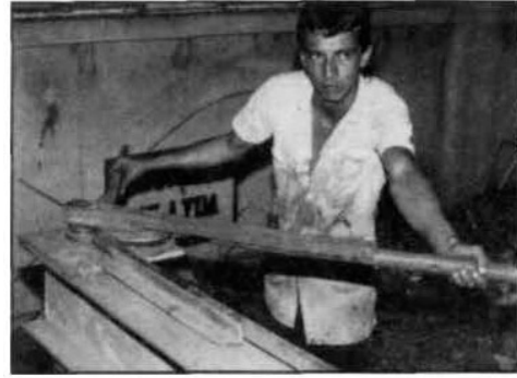
Fig. 17. Proceso de doblado de una contracostilla (refuerzo posterior y apoyo para los travesanos de las costillas del plato). Aunque bastaría con 2 carretes, se utilizan 2 adicionales para hacer el otro doblado del ducto, y conseguir de esa manera uniformidad en el conjunto.
