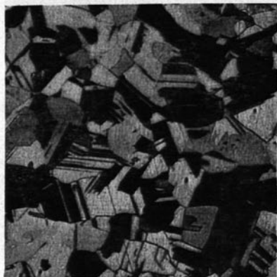
(d) 16 min. at 550 deg. C. Av. G.S. = 0.080 mm.
